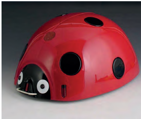
A szegedi katicabogár. A fényre és hangra működő robot a feltételes reflexek működését modellezi
